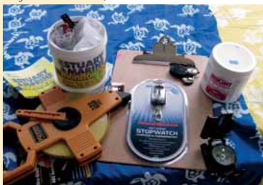
*Equipo Guardarenas, en sentido horario empezando por la izquierda: cinta métrica, equipo de medición de la calidad del agua, portapapeles, lupa, tabletas colorantes, brújula, cronómetro.*
