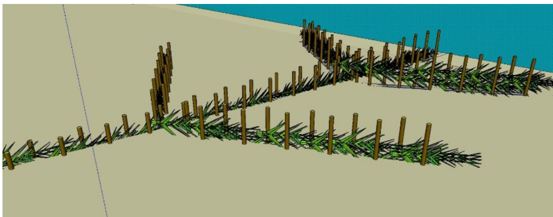
Figure 1: Le "garnissage" d'un épi complet
